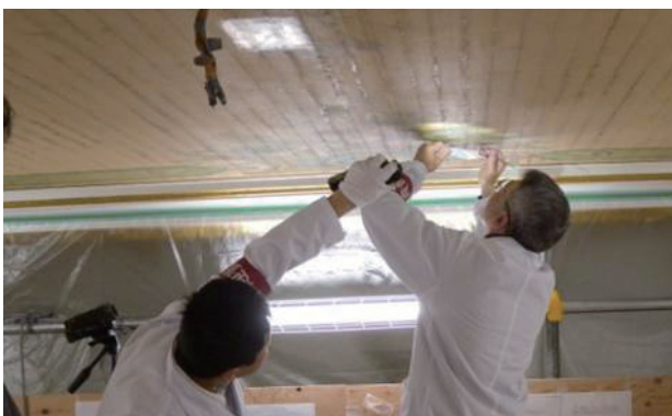
図3 メスにて試料片採取、薬包紙で受ける
