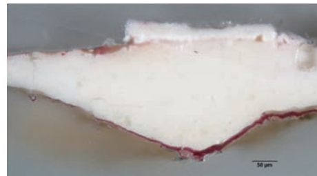
試料片 7 染色試験後 試料片 6 と同様な結 果を示す。 最下層に膠水を塗布 した絶縁層の呈色が 顕著に観察できる。
