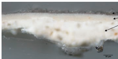
試料片 10 旧ワニス層 旧充填剤は水性のため、水性研磨で削られている。 剥落部分に直接充填された例
