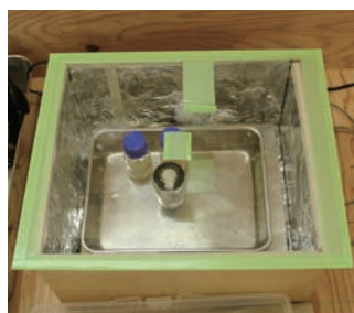
図5 作業中、膠水がゲル化しないように保温器に入れた
