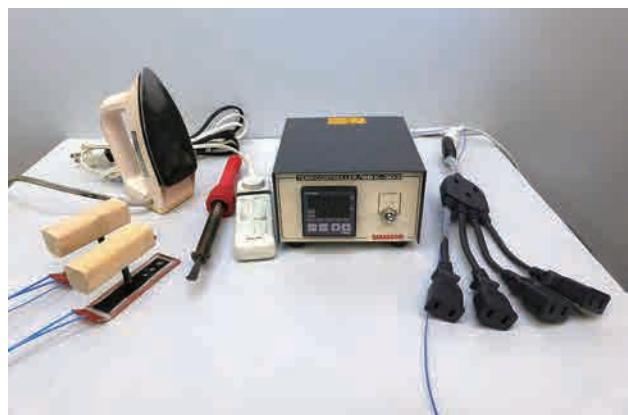
図2-45 小型アイロン、電気鎌、温度コントローラー
