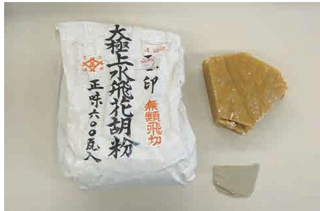
図2-102 左：胡粉、右上：混合ワックス、右下：ワックス充填材
