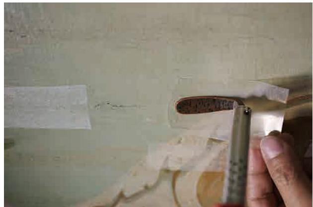
図2-50 電気鑓で加温加圧している様子
