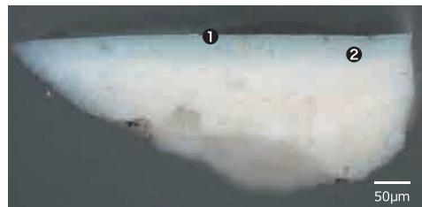
①最上層に補彩がある ②絵具層以下の2つの試料片も含めて青色顔料が特定できずエメラルドグリーンや酸化鉄系顔料が散在する。
