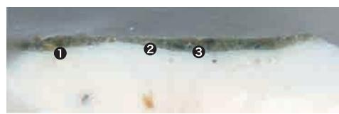
①酸化鉄系黄色顔料 ②ウルトラマリン ③コバルトブルー クロムイエロー エメラルドグリーンも含む
