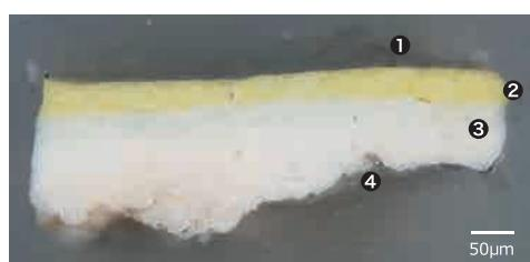
①ワニス層が確認できる ②クロムイエローと鉛白の絵具層 ③空を構成する層 ④地塗層と浮き上がり接着のワックスも透明な層として確認できる
