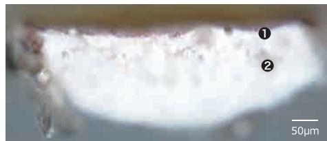
①補彩 ②充填材 水彩の補彩と水性充填材のため研磨面が削られて全体に焦点は合わない。
