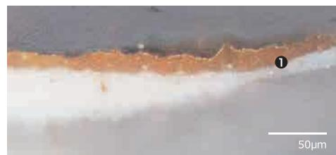
①金箔下の層では少量の酸化鉄系顔料やクロムイエロー、鉛白も含む
