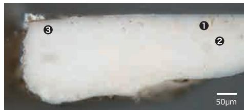
①酸化鉄系顔料を含む絵具層 ②地塗層 ③左端上部にオリジナルのワニス または油脂分の多い褐色部がある。その上は充填材である。
