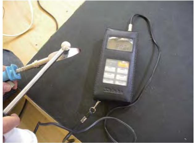
図2-2-45 電気鎔の温度の設定
