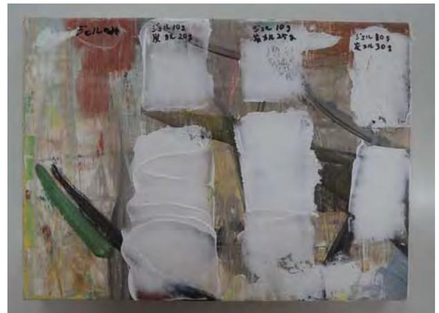
図2-4-64 2012年（平成24年）に行ったMSA Gelと炭酸カルシウムによる充填剤塗り付け試験
