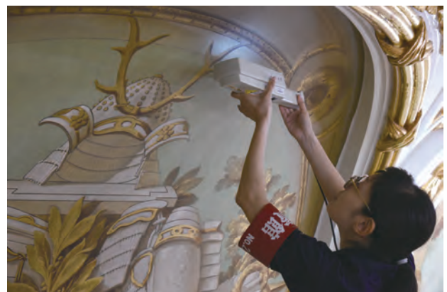
図 3-2-23 状態記録調査 紫外線検査灯で確認しながら旧補彩調査を行った。
