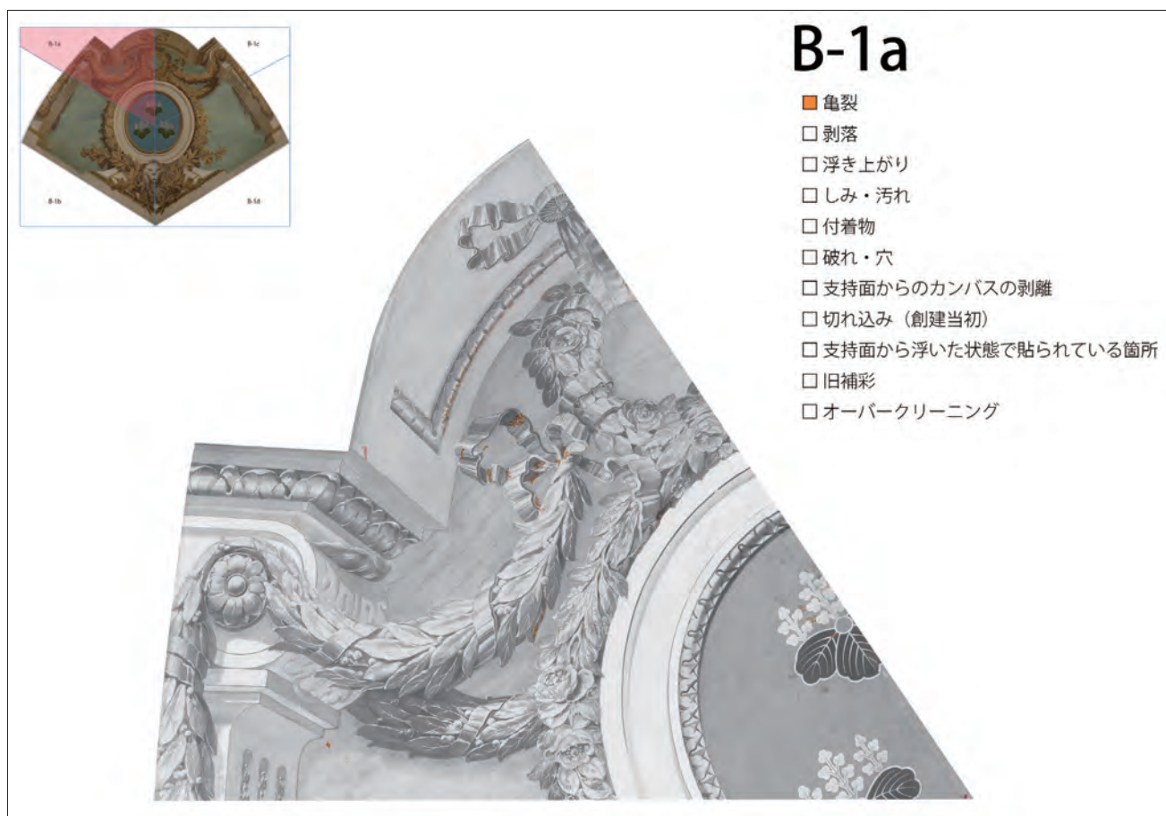
図 3-2-32 壁画 B-1 亀裂
