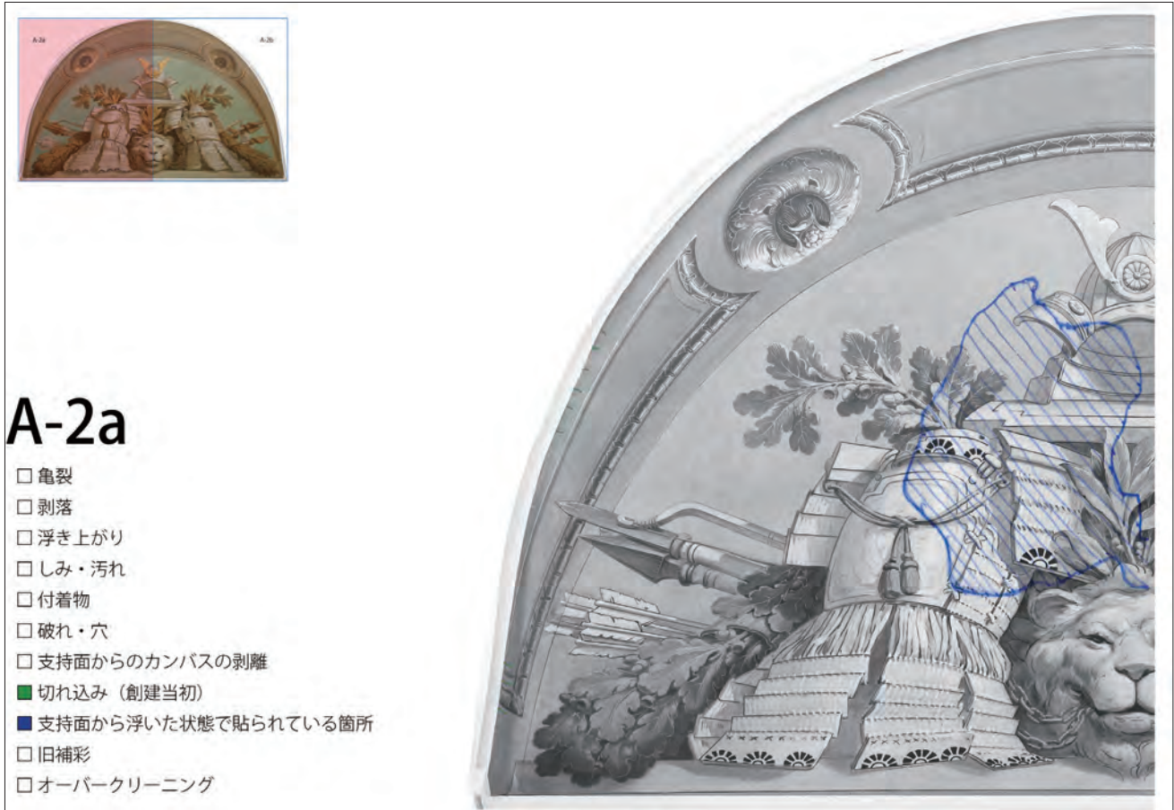
図 3-2-28 壁画 A-2 カンバスと壁とが接触していない箇所・切れ込み（創建当初）
