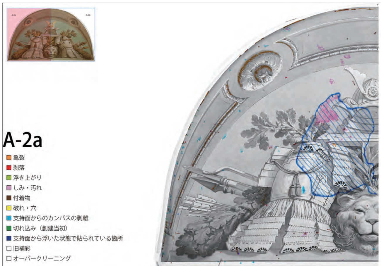
図 3-2-30 壁画 A-2 全損傷項目の重ね合わせ
