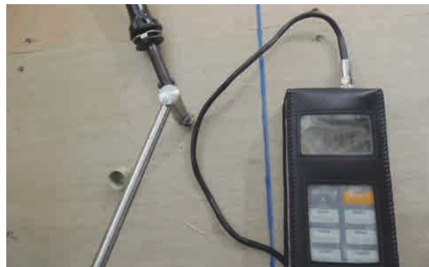
図 2-4-10 電気鋺（コテ）先の温度を 75℃ 前後に設定
