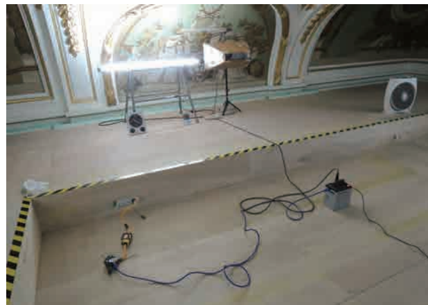
図 2-2-14 側光線撮影 ストロボの設置
