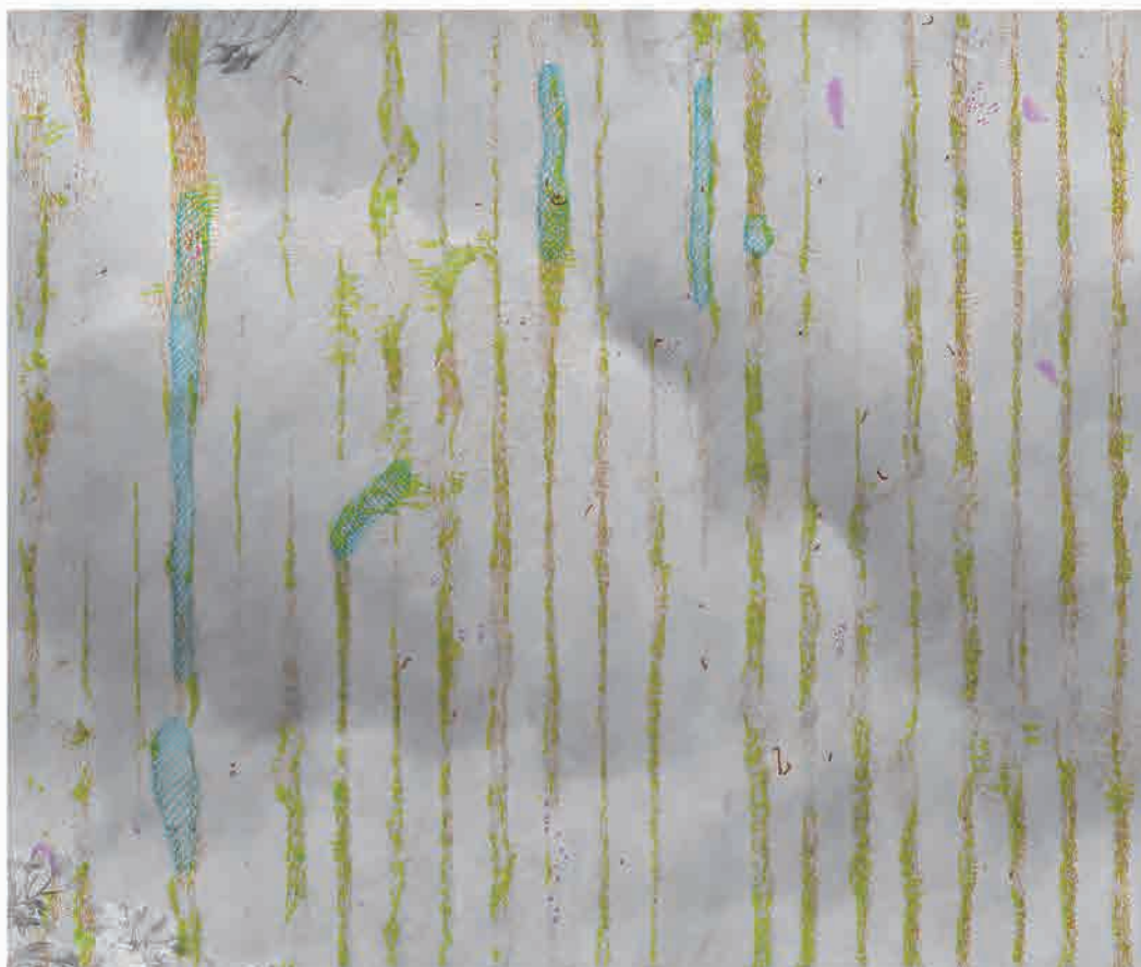
図 2-2-44 状態記録表 6F (全損傷項目の重ね合わせ)
