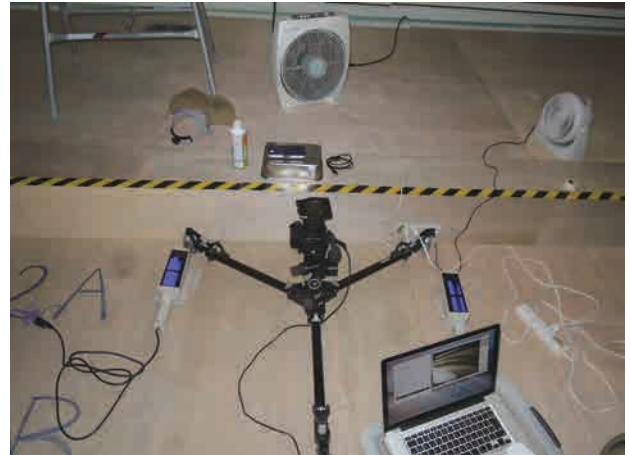
図 2-2-19 紫外線蛍光撮影 照明の設置
