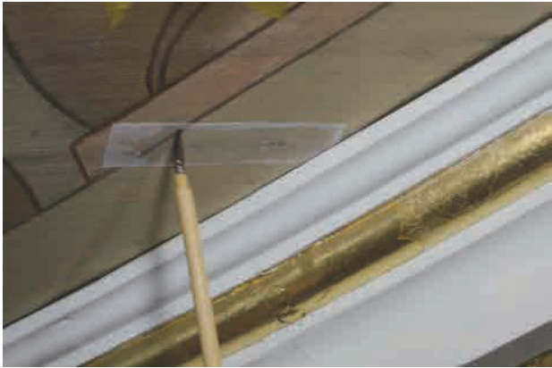
図 2-2-63 HM膠を用いた接着テスト
