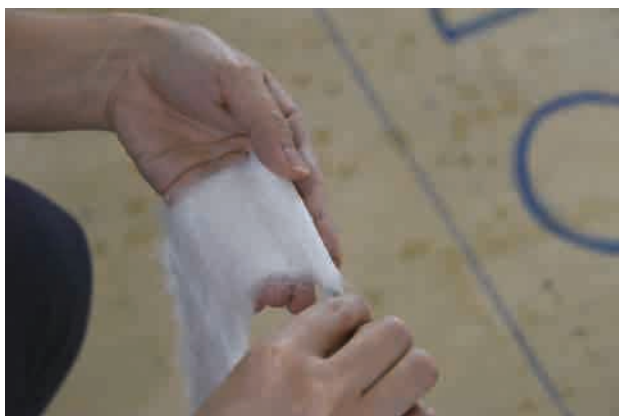
図2-4-27 画面洗浄 第2工程 作業員全員同じ幅の脱脂綿を使用した。
