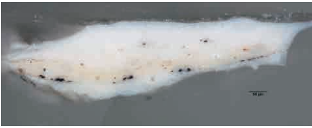
図 2-2-90 天井絵画 女神の着衣からの試料片 クロスセクションの光学顕微鏡による観察 地塗層の上に下描きのカーボンブラックが顕著に残る。
