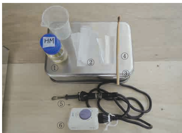
図2-4-13 浮き上がり接着道具
