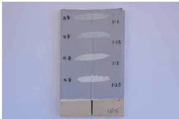
図2-4-62 固着力テストサンプル 1：2の充填剤は現在も固着は良好である。
