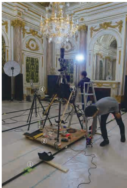
図 2-2-5 撮影機材の設置 1. 床に引かれたレール 2. キャスター付きの板台 3. HASSELBLAD H5D 4. ストロボ
